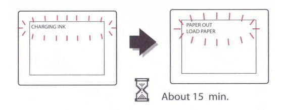
Quand le méssage « LOAD PAPER » apparait, les encres sont correctement installées.
