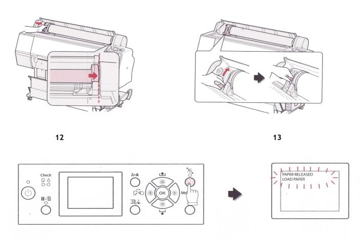
Appuyez sur ce bouton après avoir mise en place le rouleau, l'imprimante va procéder la mise en place du film.
